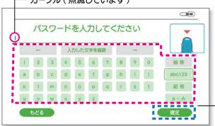
② SSID のパスワードの文字をジョイスティックで選び、 1文字ごとにペントップボタンを押して決定してください。 入力が終わったら「確定」を選び、ペントップボタンを押してください。
