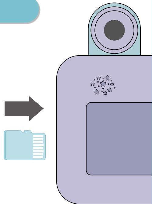
図のような向きでmicroSDカードを、カチッと音がするまで押して装着してください。再度、microSDカードをカチッと音がするまで押し込むと、取り外すことができます。
