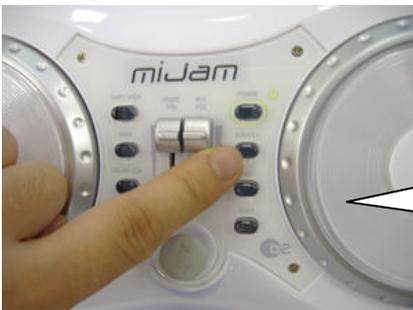
電源の下の子のボタンを使って、スクラッチの音を変化させることができます。
