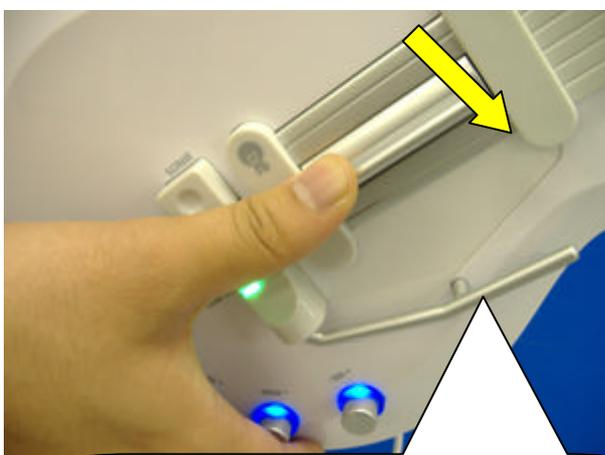
レバーを下に押しと音が鳴ります。のコードによって音は変化します。
