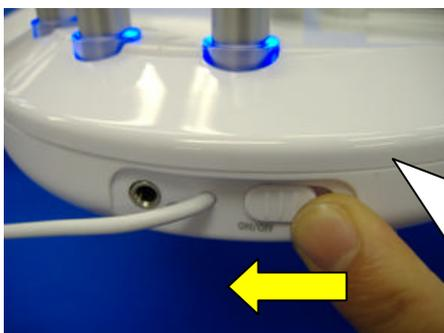
横側のON/OFFスイッチをONの方にずらし、電源を入れます。
