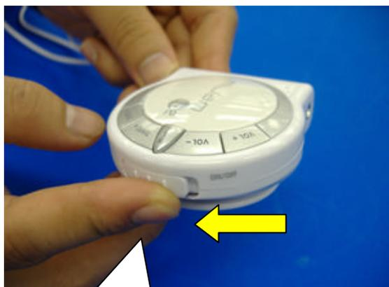
リモコンの横側のON/OFFスイッチをONの方にずらし、電源を入れます。
